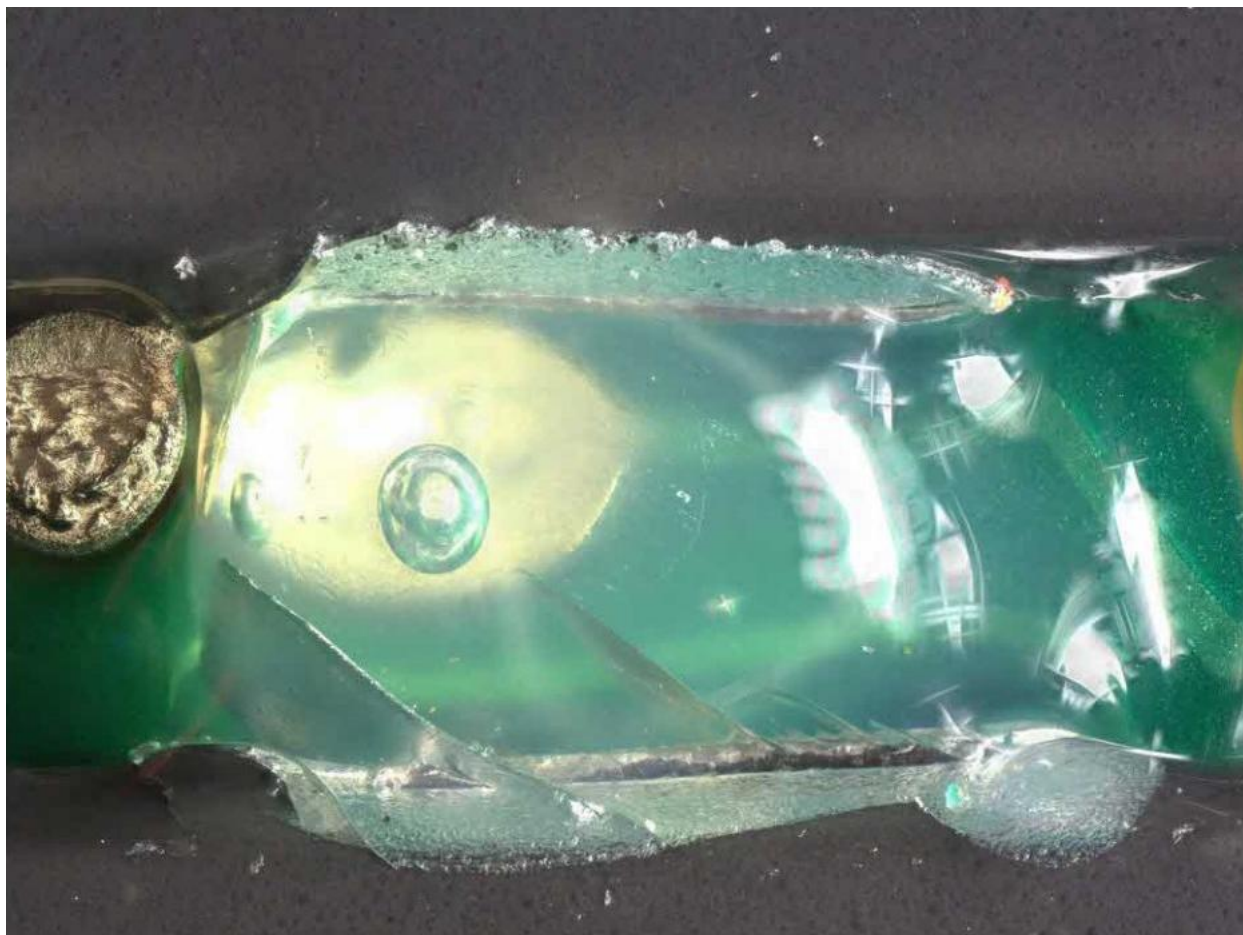
图9. 芯片U1与U2之间环氧粘接处可见裂纹示例。
