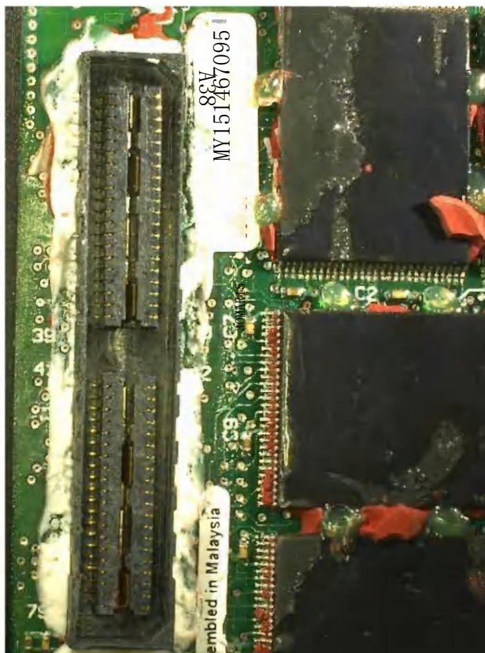
图3. CVR 存储模块连接器的细节（如收到时所示）。
