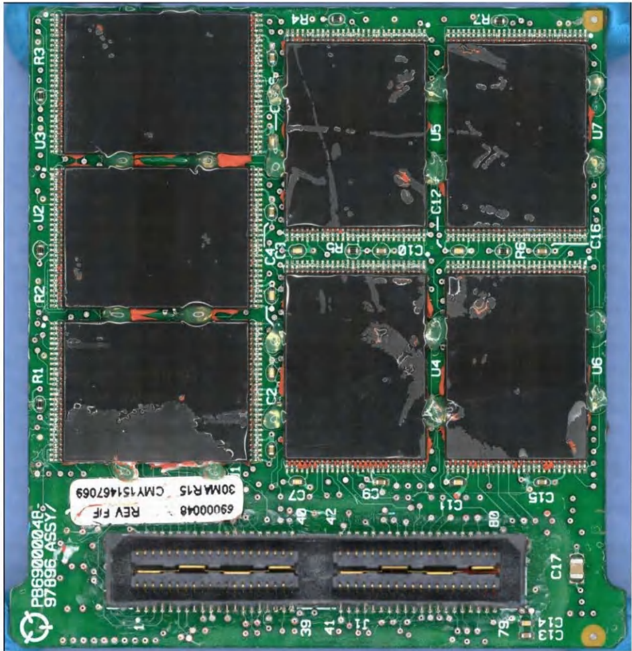
图1. CVR 内存模块板，连接器侧。
